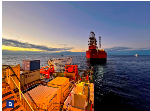
B FPSO Fluminense visto do convés do Boka Falcon durante a recuperação das linhas de ancoragem
